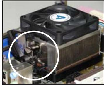
4. Abaissez le crochet de rétention vers le mécanisme de rétention pour fixer le dissipateur et le ventilateur à la base du module.
