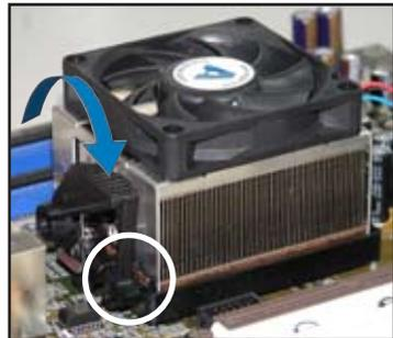
5. Lorsque l'ensemble dissipateur-ventilateur est en place, connectez le câble du ventilateur CPU au connecteur CPU\_FAN de la carte mère.
