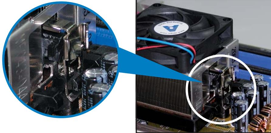
3. Alignez l'autre extrémité de l'attache de rétention (près du loquet de rétention) à la base du module de rétention. Lorsque que l'attache de rétention est bien en place, un cliquetis se fait entendre.
