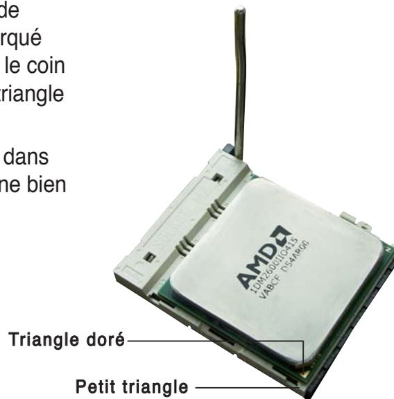
5. Quand le CPU est bien en place, refermez le levier du socket pour fixer le CPU. Le levier produit un clic en se refermant sur l'onglet latéral, ce qui indique qu'il est bien verrouillé.
