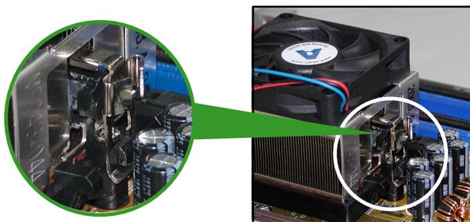
3. Alignez l'autre extrémité de l'attache de rétention (près du loquet de rétention) à la base du module de rétention. Lorsque que l'attache de rétention est bien en place, un cliquetis se fait entendre.
