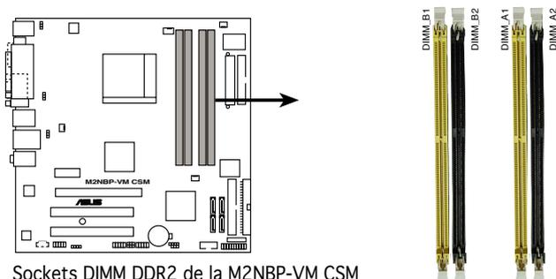
Sockets DIMM DDR2 de la M2NBP-VM CSM
