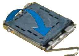
4. Heben Sie die Deckplatte mit dem Daumen und dem Zeigefinger bis zu einem Winkel von 100° an (A). Drücken Sie die PnP-Abdeckung von der Deckplattenaussparung, um sie zu entfernen (B).
