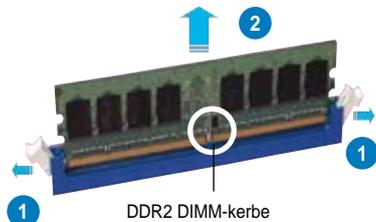
2. Entfernen Sie das DIMM-Modul vom Steckplatz.
