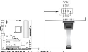
F2A85-M PRO Serial port (COM1) connector
