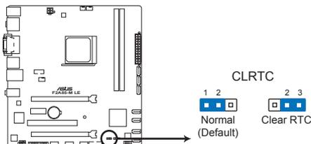
Jumper d'effacement de la mémoire RTC de la F2A85-M LE
