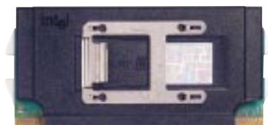
リテンションクリップの不適切な取り付け例
