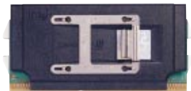
リテンションクリップの適切な取り付け例
