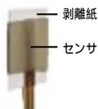
**警告!** センサを CPU とヒートシンクの間にはさまないようにしてください。センサが破損します。
